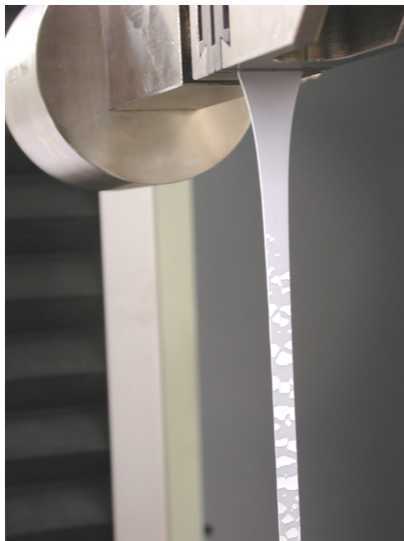
Bild 2: Eingespannter Probekörper, bestehend aus „Mariseal®250“ (weiss) und gerissener UV-Schutzschicht „Mariseal®400 Top-Coat“ (grau)
